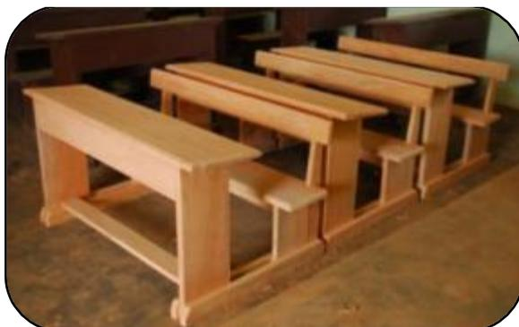
Figure 21 : bancs d'écolier construits lors de la formation en menuiserie (Photo : Meunier Q.).
