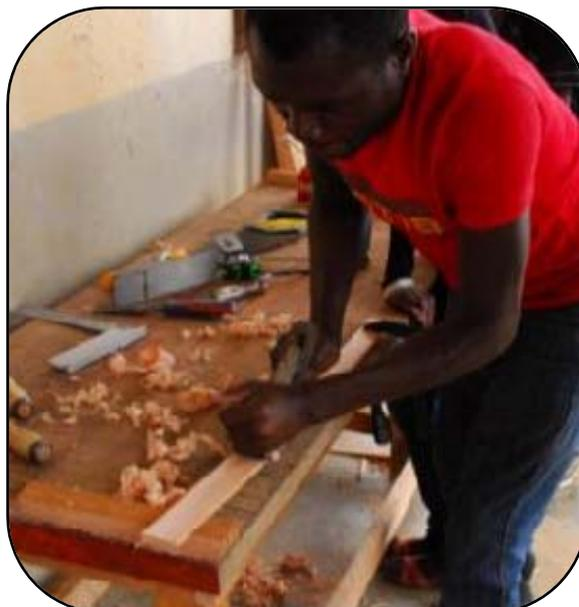
Figure 19 : travaux de rabotage pour le façonnage de lattes issues d'une planche grossière d'Okoumé lors de la formation en menuiserie (photo : Meunier Q.).
