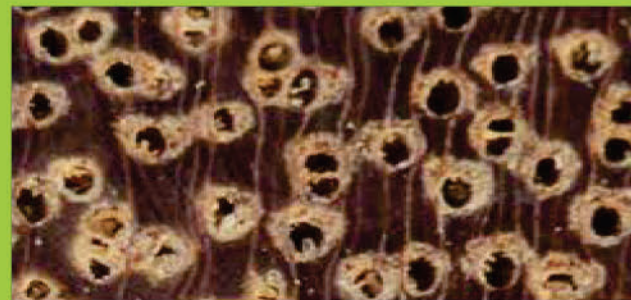
Lỗ mạch đơn và kép ở gỗ Lim xanh ( E. fordii )
