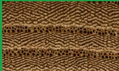
Mạch gỗ xếp thành dãy tiếp tuyến Elm ( Ulmus spp. )
