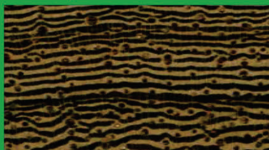
Dải mô mềm lớn hơn hoặc bằng độ rộng lỗ mạch Pheasantwood
