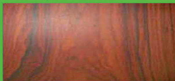
Sọc màu đen trên mặt tiếp tuyến gỗ Trắc ( Dalbergia cochinchinensis )
