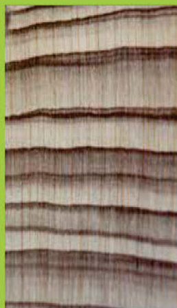
Chuyển tiếp đột ngột và cả từ Sa mu đầu ( C. konishii )
